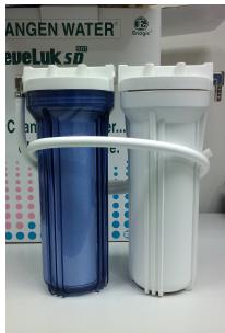
左边透明蓝色容器内为纤维滤芯, 右边白色容器内可选择使用 KDF 滤芯, ION 树脂滤芯或抗菌活性碳滤芯。有需要时可再连结一个白色滤芯成为 3 连式前置滤芯。用途为去除水中的污染物质。当发现整个纤维滤芯的颜色由白色变成咖啡色时便需更换。
